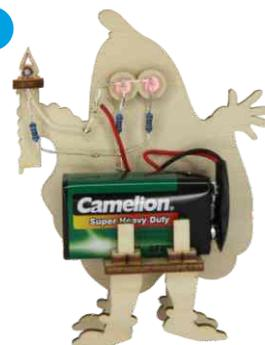
**ATTENTION !** Les fils qui sont soudés aux résistances ne doivent pas toucher les fils des contacts Plus. Dans le cas contraire, un court-circuit peut survenir, et entraîner une pile défectueuse !
