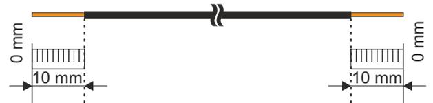
3 Pré-étamer ensuite l'un des deux côtés dénudés par câble avec le fer à souder et un peu d'étain à souder.
