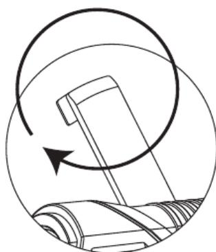
Tournez la manivelle à 120 - 150 tr/min (2 à 2,5 fois par seconde). 1 minute de rotation peut alimenter la radio pendant environ 3 minutes.
