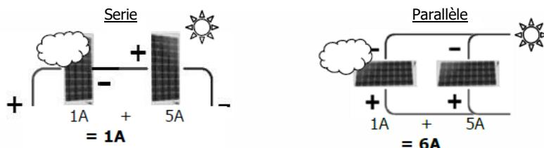
Dans le cas d'un couplage parallèle, la puissance des panneaux s'additionne
