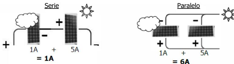
En el caso de un acoplamiento paralelo, la potencia de los paneles se suma.
