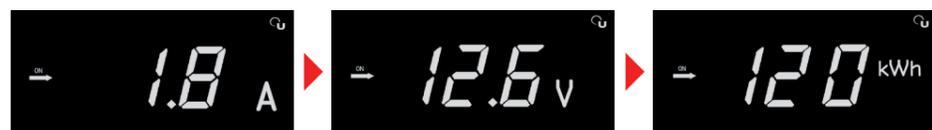
Courant instantané en DC consommé (A), tension instantanée de la sortie DC (V), et historique de consommation (kWh).
