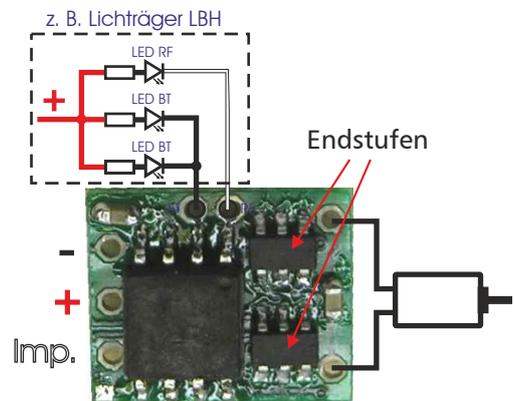
Abmessung: 12 x 10 x 2,5 mm
