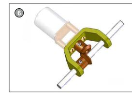
Das Getriebe wird nun bei geringer Spannung in Betrieb genommen. Es sollte leicht und ohne zu klemmen laufen. Ist die nicht der Fall, können die Zahnräder durch Lösen der Madenschrauben leicht ausgerichtet werden.
