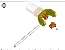
Die Achse ist so zu positionieren, dass die abgeflachte Stelle mit der Lage der Madenschraube des zweiten Kegelzahnrades übereinstimmt.
