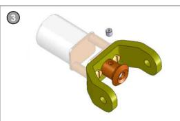
Nun die Schraube an der abgeflachten Seite der Motorwelle festziehen.
