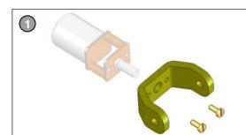
Die Achshalterung wird mit den beiden Schlitzschrauben am Motor befestigt.
