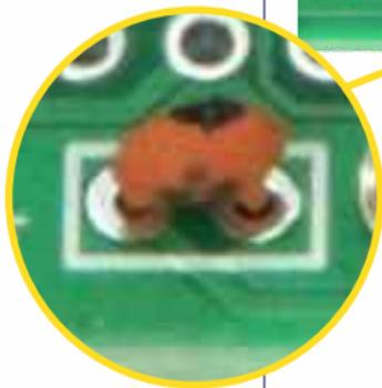
Löte nun die beiden Kondensatoren auf und erst danach den Quarz...
