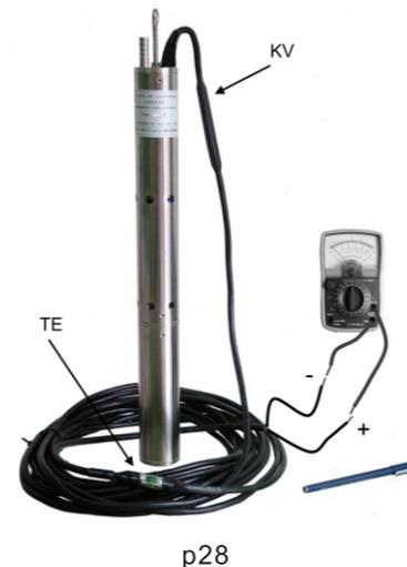
G11.0) Lorsque le + du multimètre est relié au - de la pompe et le - du multimètre est relié au + de la pompe (branchement en croix) la valeur mesurée est de 0,5-5,0K Ohm et peu à peu augmenter.
