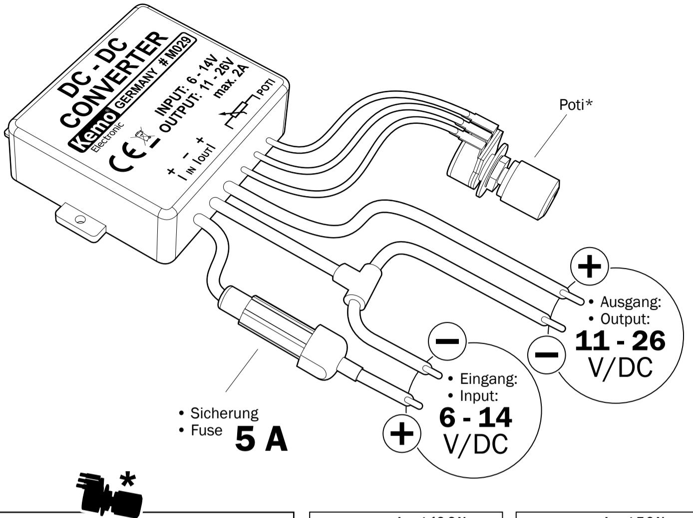
**Achtung:** Mit dem zusätzlichen (Poti 4,7k lin.) kann die max. Ausgangsspannung je nach Belastung auf ca. 18 - 23 V begrenzt werden. Das Potentiometer wird nicht mitgeliefert!
